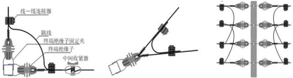
同一分区拐角合金线连接（俯视图，上图中左）、拐角 $\leq 30^\circ$  同一分区拐角合金线连接（俯视图，上图中）、不同分区终端杆两边合金线连接（上图中右）
